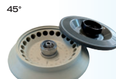
Rotor angular, 24 espacios N° de Ref. 01226 n = 13,300 min -1 , máx RCF 17,008
