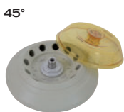
Rotor angular, 12-espacios N° de Ref. 01252 12 espacios, n = 13,300 min -1 , máx RCF 14,041
